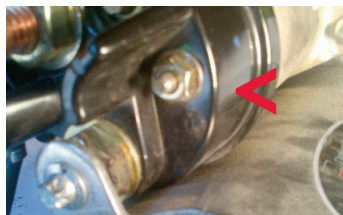
Buena terminal con tuerca de respaldo instalada de fábrica correctamente
